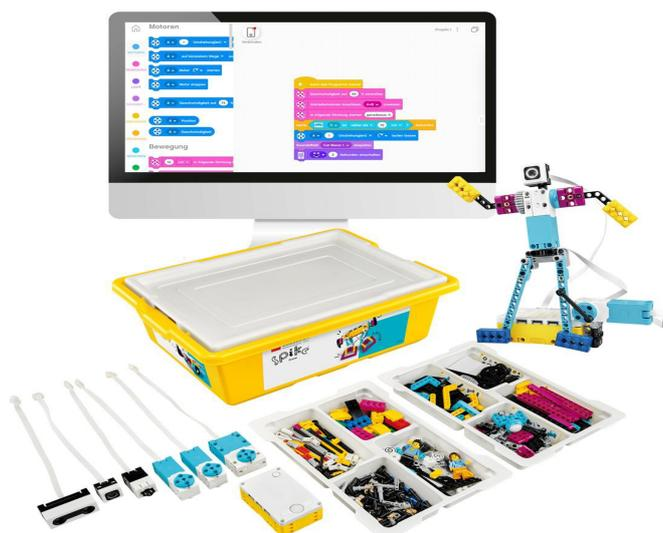
**LEGO:** proprio il kit di costruzioni formato da mattoncini colorati; ma molto di più di un gioco: **SPIKE Prime**, questo kit contiene motori, sensori e un "hub" programmabile multi porta.
